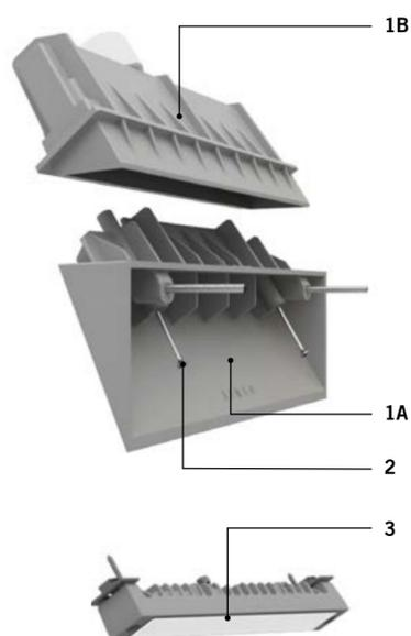
Ghost è un **incavo luminoso** che si ottiene tramite l'utilizzo di un'apposita cassaforma da ancorare al cassero prima del getto in calcestruzzo. Una volta che il calcestruzzo è asciutto, parte della cassaforma può essere rimossa per ricavare un vuoto, un calco netto e definito formatosi a seguito del processo di indurimento.
